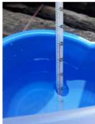
Gambar 5 Pengukuran suhu pada sampel air
