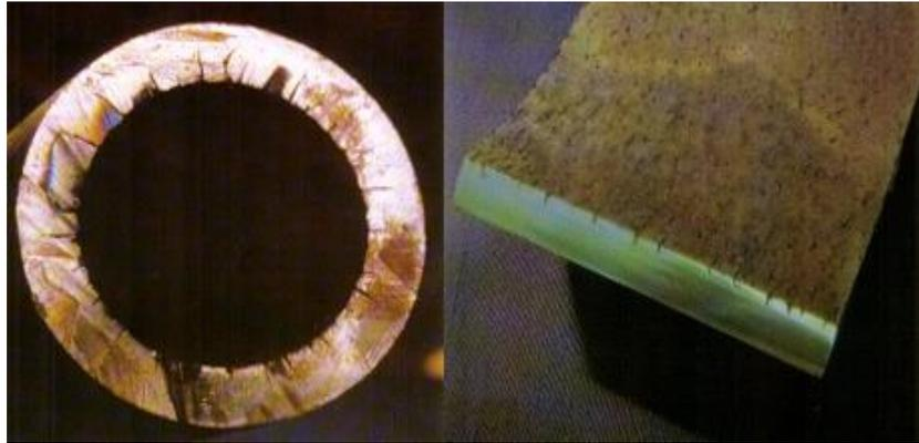
**Gambar 2. 8** Tube yang mengalami *corrosion fatigue*
