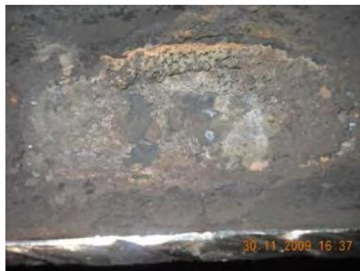
**Gambar 2. 23** Bekas endapan deposit pada *U-bend Superheater tube Boiler 31F-28*
