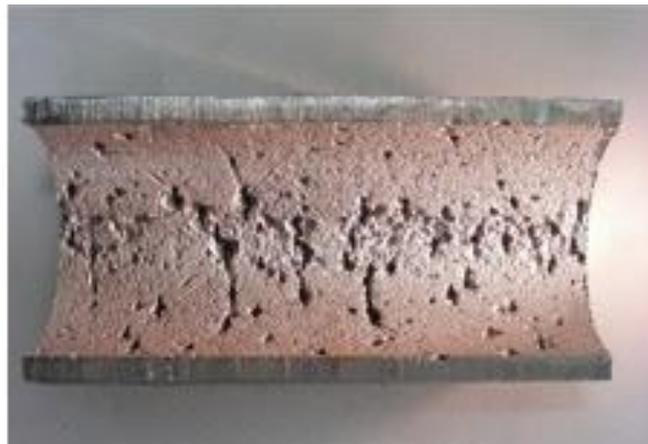
**Gambar 2. 19** *Oxygen pitting* pada *tube Boiler*
