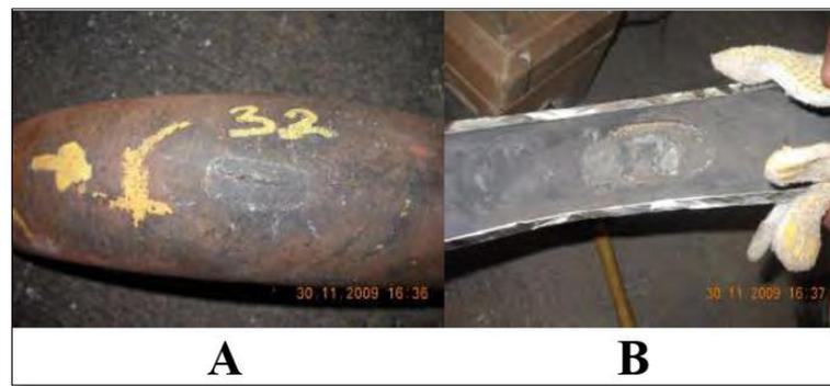
**Gambar 2. 22** Pengelembungan pada *U-Bend Superheater tube* (A).
