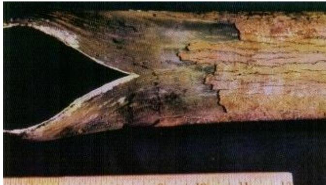
**Gambar 2. 13** *Tube* yang mengalami *Long-term overheating*
