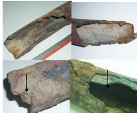
**Gambar 2. 25** Foto makro *tube Superheater* yang mengalami kegagalan
