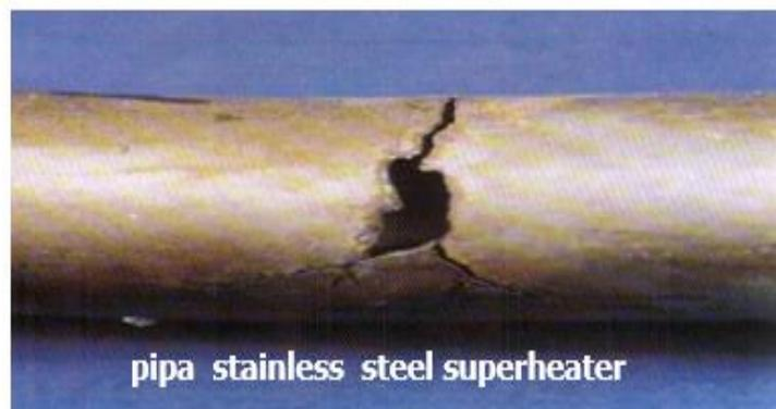
**Gambar 2. 10** Tube yang mengalami SCC
