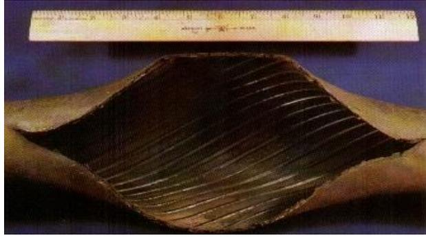
**Gambar 2. 12** Tube yang mengalami *short-term overheating*
