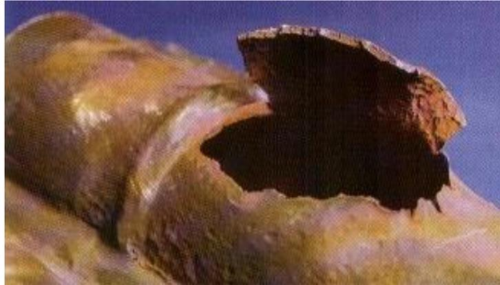
**Gambar 2. 14** Tube yang mengalami hydrogen damage
