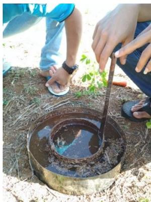
Gambar 20. Pengukuran laju infiltrasi
