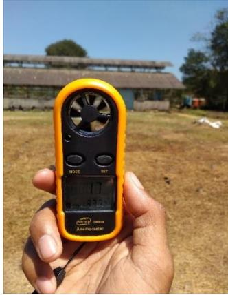
Gambar 26. Pengukuran kecepatan angin
