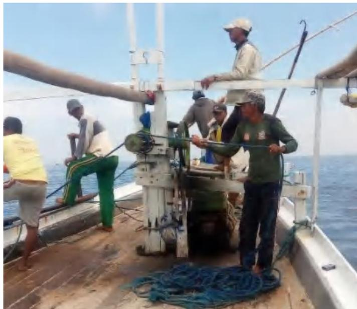
Gambar 20. Penarikan Tali Kolor Dengan bantuan mesin *Roller*
