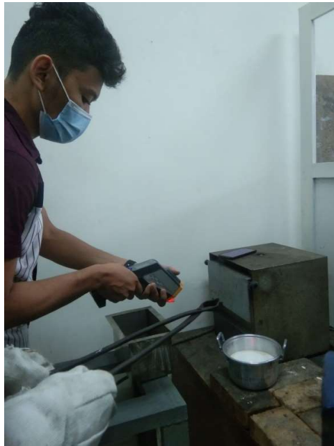
Lampiran 5. 2 Mendinginkan spesimen di dalam media pendinginan.
