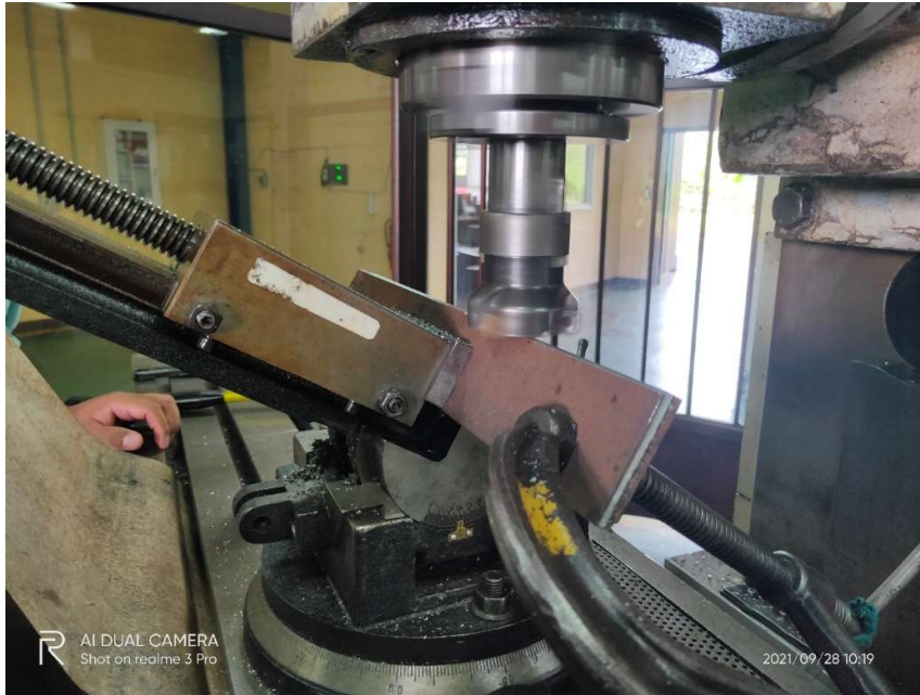
Lampiran 1.3 Pembuatan kampuh V dengan sudut 30^\circ menggunakan mesin frais .
