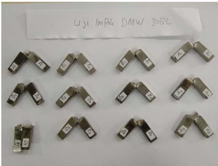
Lampiran 7.4 Hasil perpatahan setelah diuji impak.
