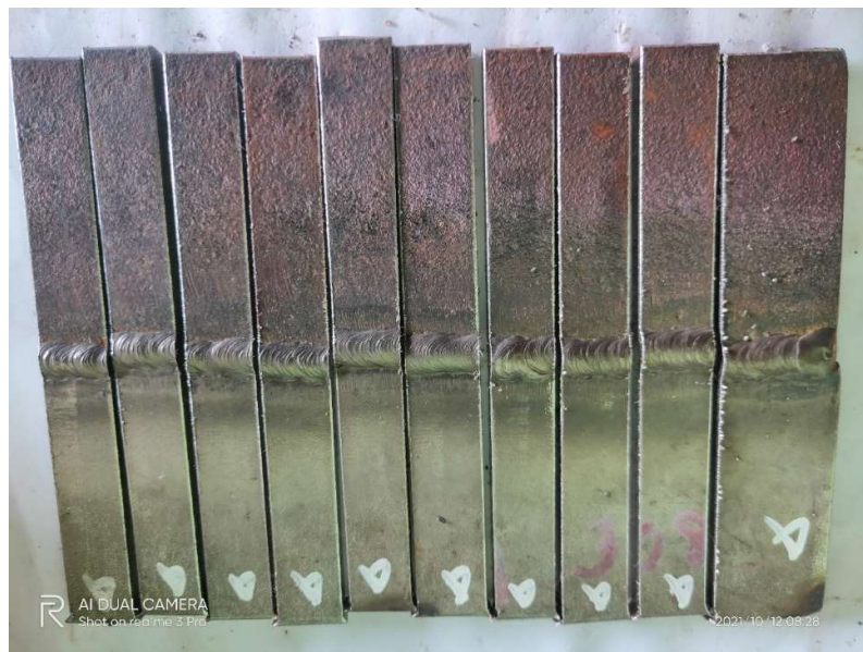
Lampiran 4. 2 Sampel pengelasan yang telah dibagi-bgi dengan lebar ukuran masing-masing 13 mm.
