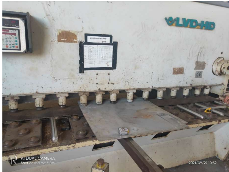
Lampiran 1. 1 Pemotongan plat AISI 316L ukuran 800 mm × 800 mm × 6 mm menjadi ukuran 200 mm × 100 mm × 5 mm dengan menggunakan mesin shearing .
