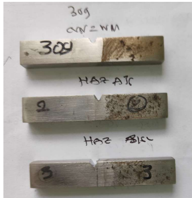
Lampiran 4. 4 Model spesimen untuk pengujian impak (standar ASTM E23).
