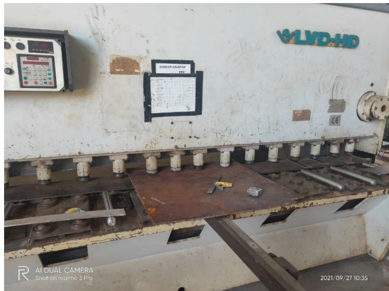
Lampiran 1. 2 Pemotongan plat ASTM A36 ukuran 800 mm × 800 mm × 6 mm menjadi ukuran 200 mm × 100 mm × 6 mm dengan menggunakan mesin shearing .
