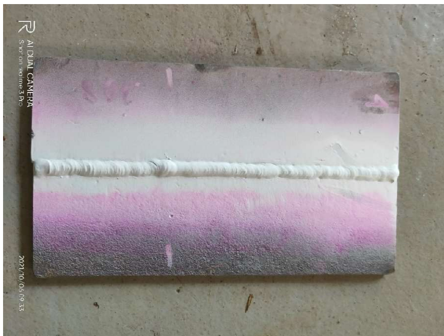
Lampiran 3. 3 Penyemprotan cleaner untuk membersihkan sampel.
