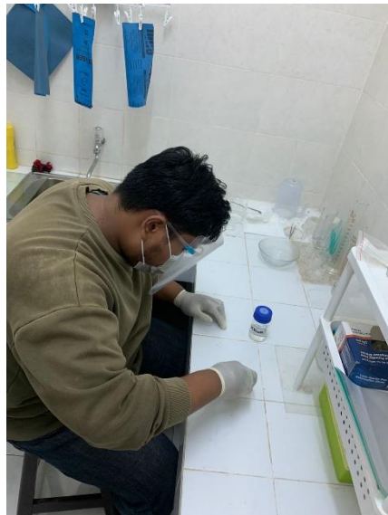
Gambar B.3 Proses Etsa Sebelem Melakukan Pengujian Mikrostruktur
