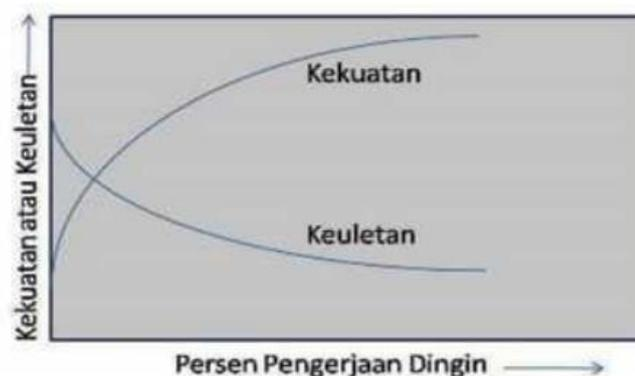
Gambar 3 Pengaruh Deformasi Terhadap Sifat Mekanik Bahan Logam
