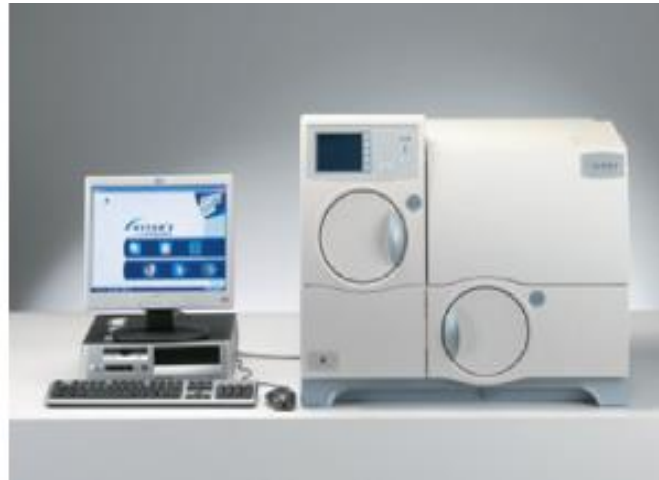
Gambar 4. Alat VITEK-2 untuk pengenalan (identifikasi), uji kepekaan antibiotika bakteri dan jamur
