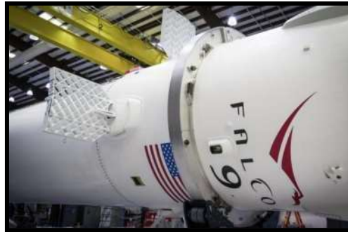
Gambar 2.5. Grid fin yang dipasang pada Roket SpaceX Falcon 9 (Faza, G.A., et al. , 2018).
