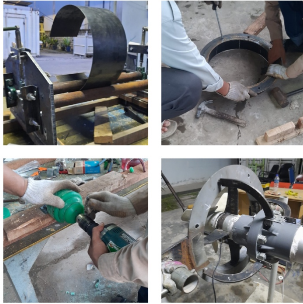
Gambar D. Proses Pembuatan Turbin Hidrokinetik
