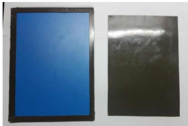
Gambar III.8 Cetakan yang digunakan (kiri), material yang dihasilkan setelah proses curing selesai (kanan)
