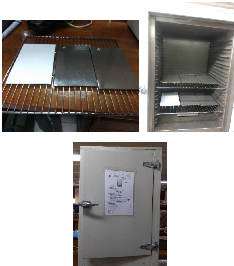
Gambar III.9 Proses menghilangkan kadar air pada sampel
