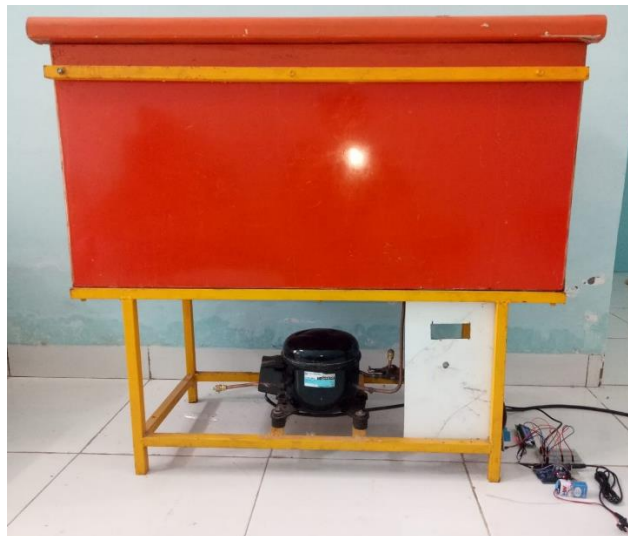
Gambar B.2 Pemasangan rangkaian thermostat arduino pada sistem pendingin
