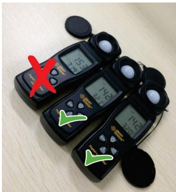
Gambar 16. Kalibrasi alat lux meter AS803 ( Smart Sensor )
