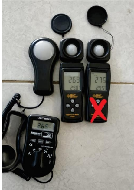
Gambar 17. Kalibrasi alat lux meter Smart Sensor AS803 dengan alat lux meter krisbow
