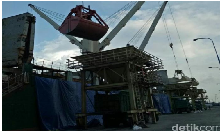
Gambar 1 Bongkar Muat Langsung ke Truck
