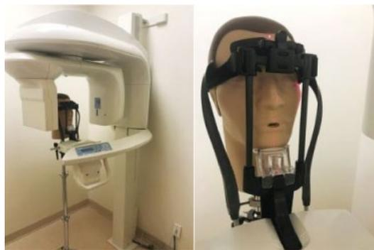
Gambar 3. A. *Cone-beam computed tomography* (CBCT) dan B. *head phantom* pada kedudukan yang dapat digerakkan ke segala arah
