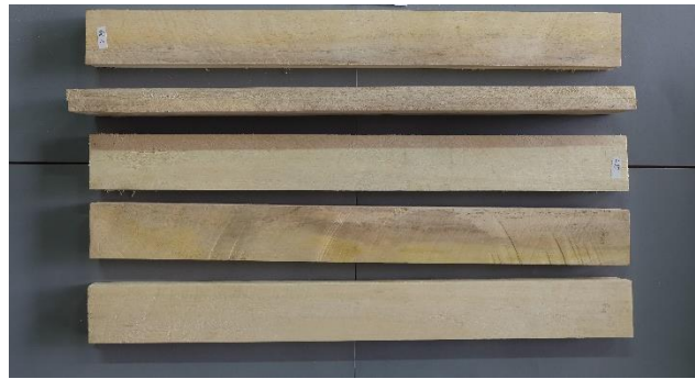
Gambar 3. Balok laminasi yang telah jadi
