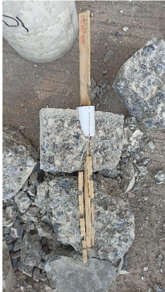
Tulangan bambu setelah diuji
