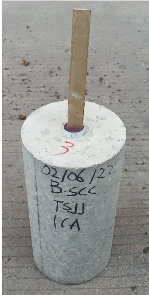
Tulangan bambu setelah diuji
