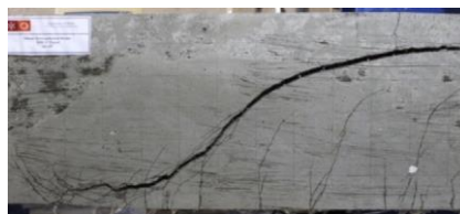
c. Pola retak pada kegagalan balok R-SP
