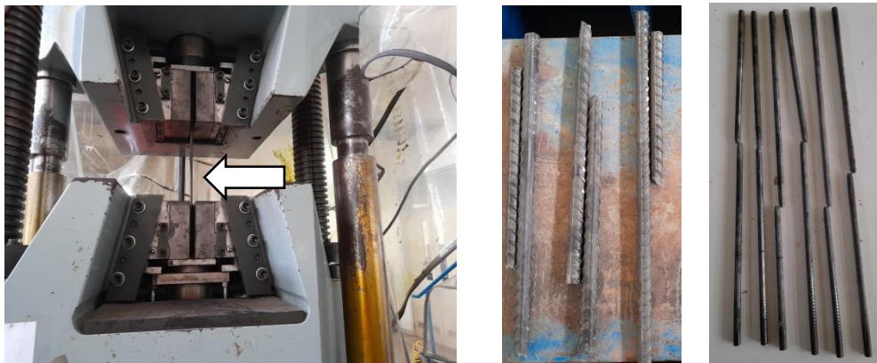
Gambar 37. Pengujian Kuat Tarik Tulangan Baja
