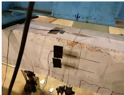
Gambar 35. Penempatan Strain Gauge Beton
