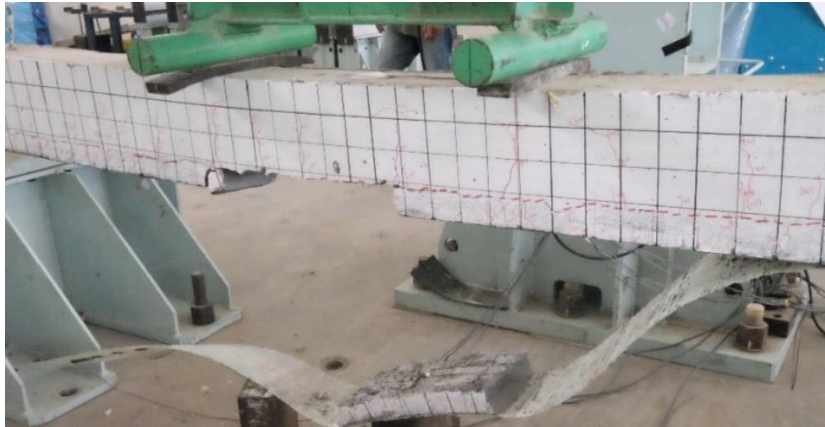
Gambar 60. Debonding Antara Beton Grouting Dan GFRP
