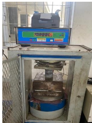
Gambar 39. Uji Kuat Tekan Mortar
