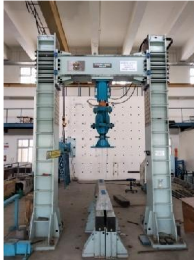
Gambar 22. Alat Uji Statik Kapasitas 1500 kN
