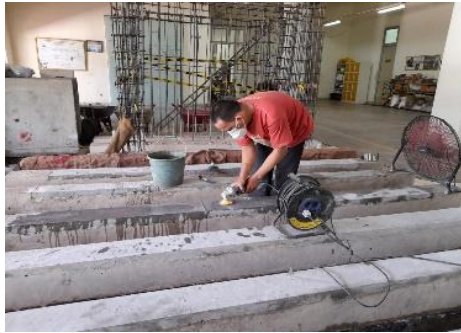
(a) Meratakan permukaan benda uji
