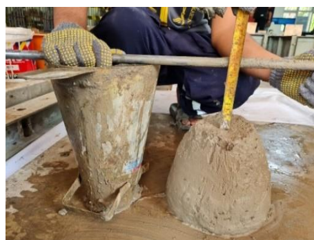
(d) Slump test
