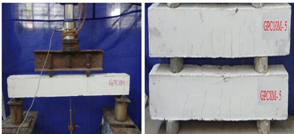
**Gambar 2.** Pengujian lentur dan pola retak pada balok
