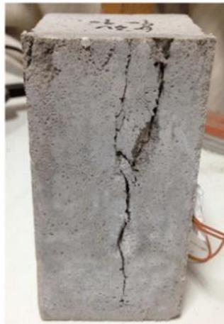
**Gambar 3.** Pola retak yang terjadi pada benda uji
