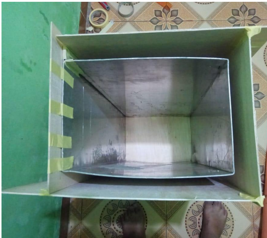
Gambar B2 : Pembuatan Isolator dengan Fom A dan Fom B
