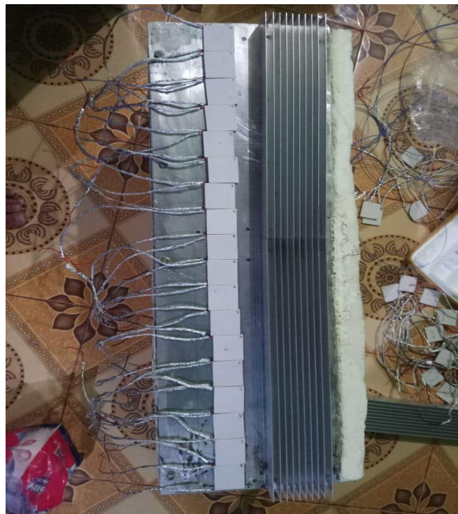
Gambar B6 : Pemasangan TEG yang telah dilapisi Termal pasta
