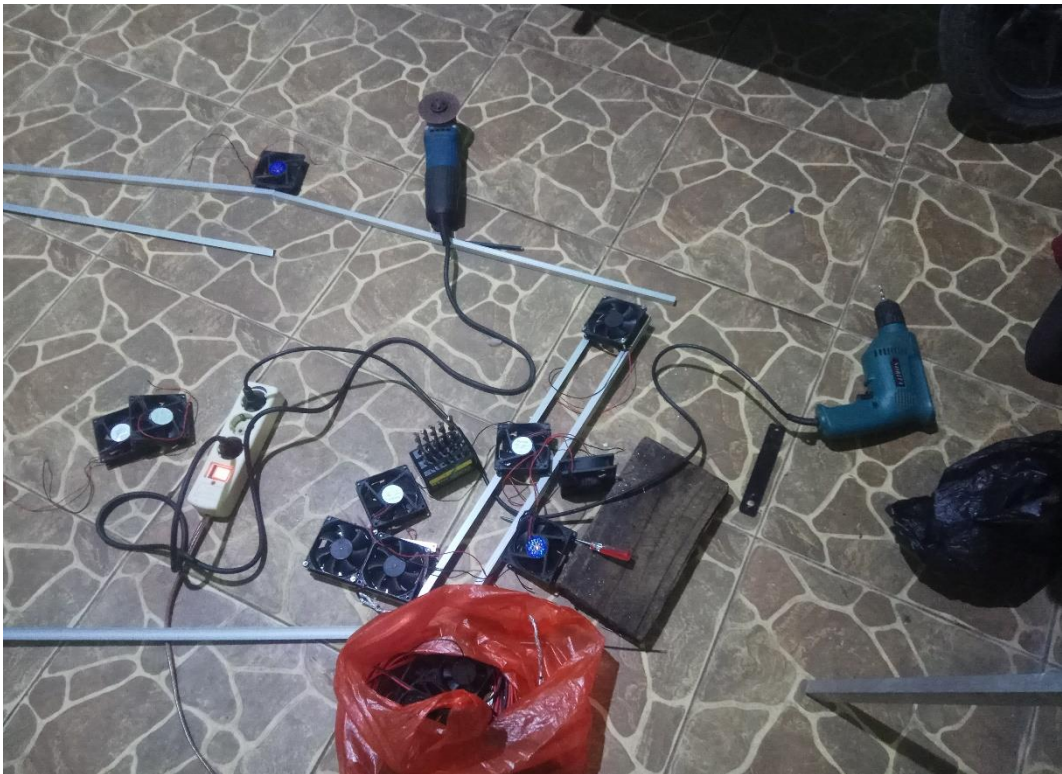
Gambar B3 : Pembuatanudukan FAN ke heatsink
