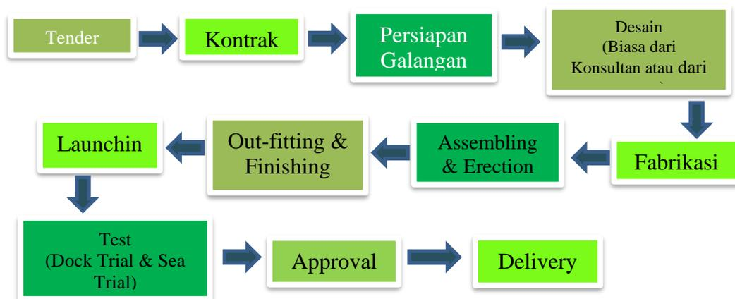
Jadi pada bagan diatas dapat disimpulkan bahwa tahapan pengkonstruksian dalam prose pembangunan kapal, yang paling utama mencakup mulai dari :
