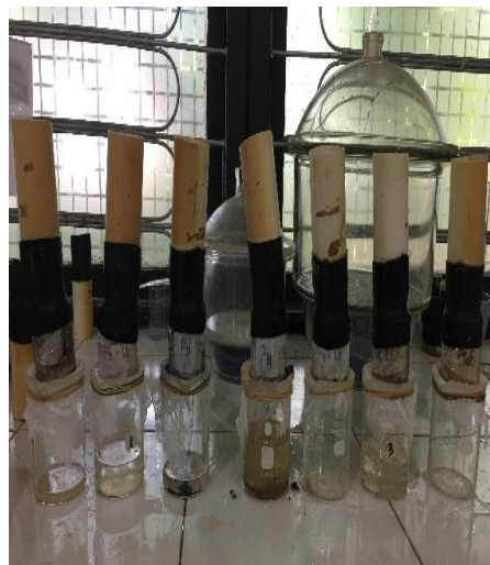
Uji permeabilitas tanah
