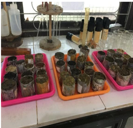
Perendaman sampel tanah tidak terusik sebelum uji permeabilitas
