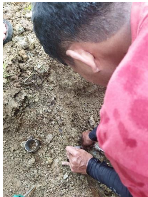
Pengambilan sampel tanah tidak terusik
