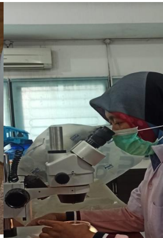
Gambar 6. Pengamatan mikroplastik pada sampel air limbah dengan menggunakan stereomicroscope di laboratorium produktivitas dan kualitas perairan Fakultas ilmu kelautan dan perikanan Unhas.
