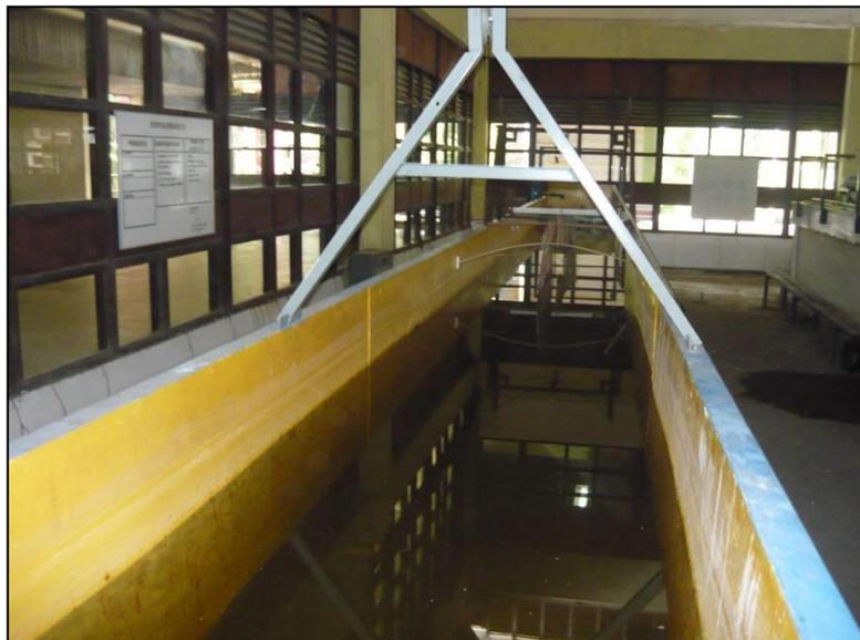
Gambar 13. Saluran Gelombang (*Wave Flume*) Laboratorium Hidrodinamika Teknik Kelautan Universitas Hasanuddin
