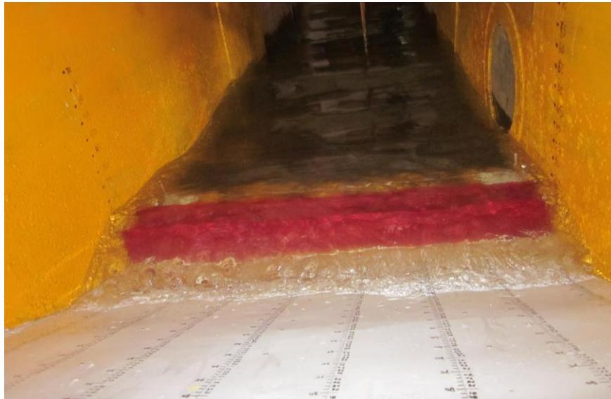
Gambar 18. Pengukuran *run up* dan *run down* pada *revetment*
