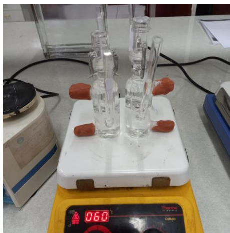
Gambar 21. Pengujian penetrasi menggunakan sel difusi Franz
