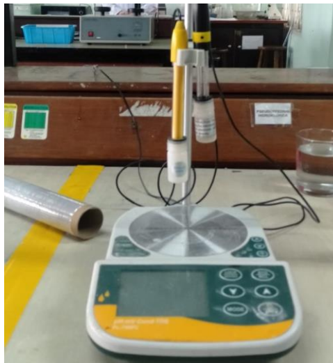
Gambar 20. Pengujian pH menggunakan pH meter Horiba ®
