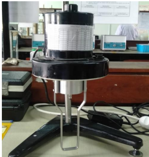
Gambar 19. Pengujian viskositas menggunakan viskometer Brookfield ®
