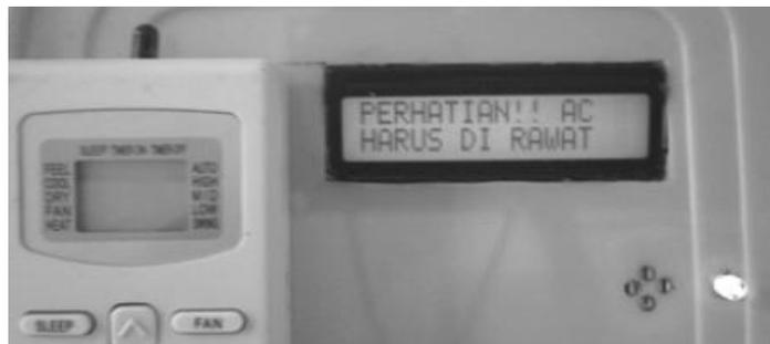
**Gambar 44.** Tampilan pengujian program pada saat AC perlu dilakukan perawatan.
