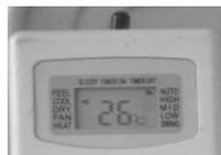
**Gambar 40.** Tampilan settingan suhu AC *remote control* pada saat tombol suhu turun ditekan.
