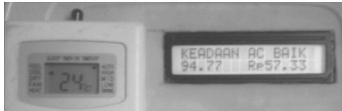
**Gambar 43.** Tampilan hasil pengujian program pada saat kompresor on dan penyaring udaranya belum kotor.
