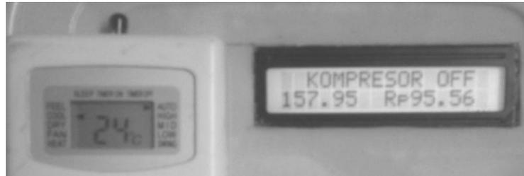
**Gambar 42.** Tampilan hasil pengujian program pada saat kompresor *off*.
