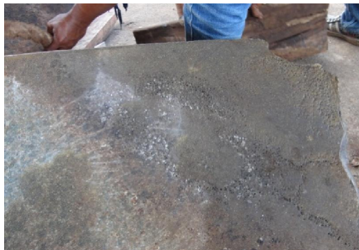
Gambar 7. Daun propeller mengalami deformasi
