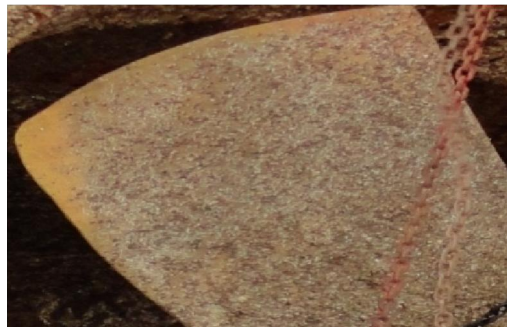
Gambar 8. Daun propeller mengalami aus
