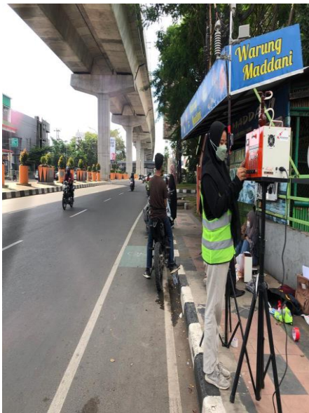
Pengambilan Sampel CO Menggunakan Impinger
