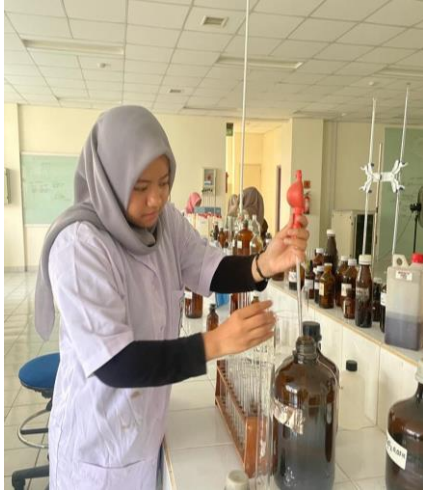
Pembuatan Larutan Penjerap Karbon Monoksida (CO)
