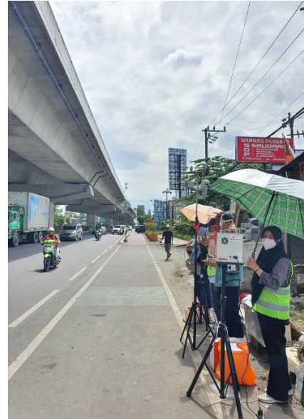
Pengambilan Sampel CO Menggunakan Impinger
