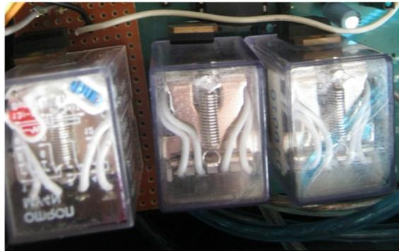
**Gambar 3.9** Rangkaian *Driver Relay*
