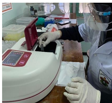
Gambar 18. Pengukuran Panjang gelombang dengan spektrofotometer UV-Vis
