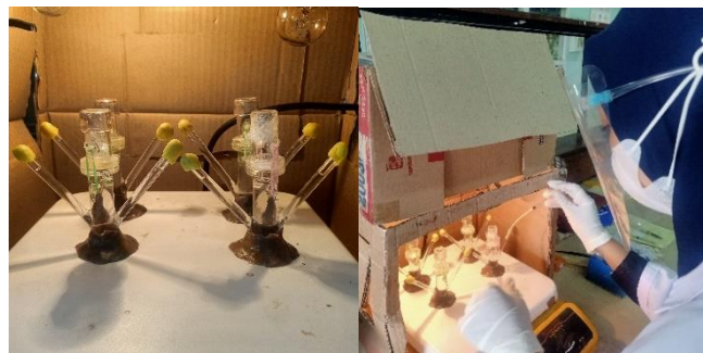
Gambar 20. Uji ex vivo menggunakan apparatus sel difusi Franz
