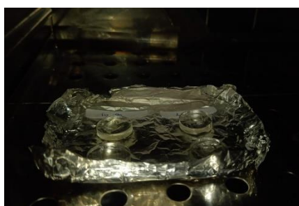
Gambar 17. Proses pengeringan DMN pada suhu 37°C menggunakan oven
