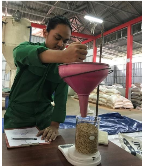
Keterangan: Uji Kerapatan Tumpukan ( Bulk Density ) Pellet
