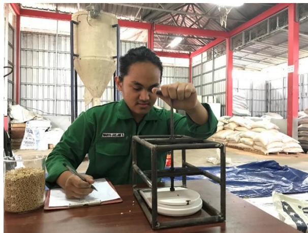
Keterangan: Uji Kekerasan ( Hardness Test ) Pellet
