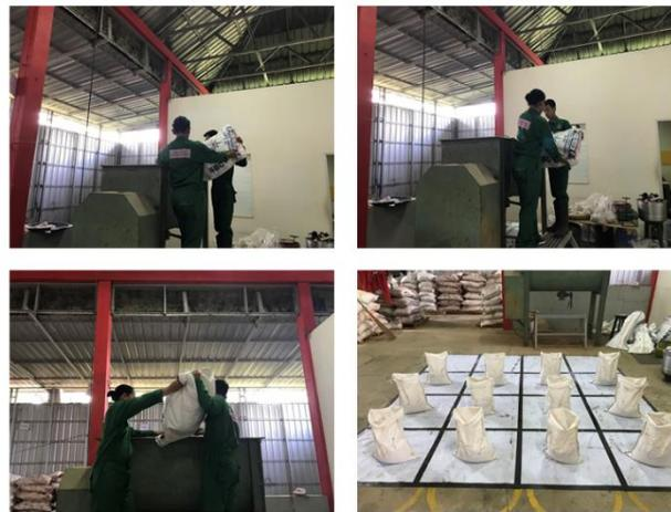
Gambar 3. Proses Pencampuran Bahan Pakan pada *Mixer Horizontal*
