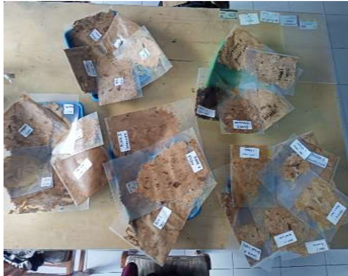
Gambar 14. Proses setelah perendaman dan dipisahkan dengan larutan, endapan ampas dipipihkan pada mika bening dan didiamkan pada suhu ruangan
