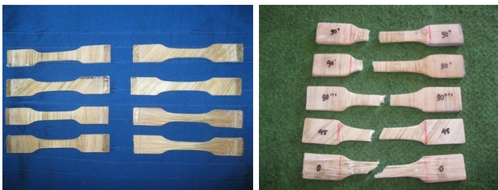
Gambar 7.7. Spesimen Uji Tarik Sebelum Dan Sesudah di Uji Tarik
