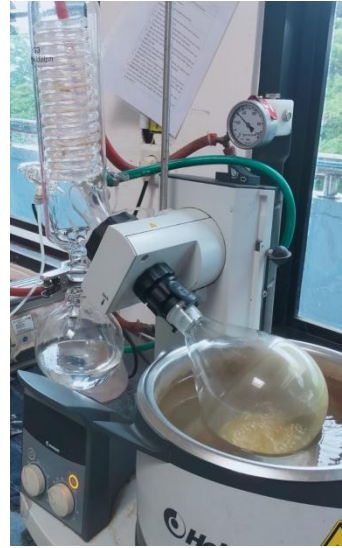
Gambar 12. Ekstrak dipekatkan dengan Rotary Evaporator
