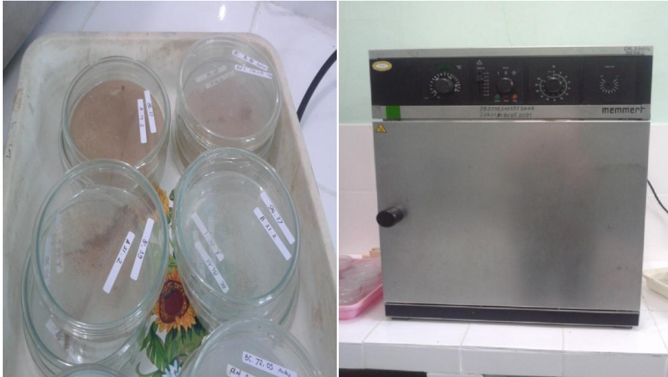
Gambar 7. Alat yang digunakan dalam kegiatan analisis sampel muatan sedimen pada Laboratorium Balai Pelatihan dan Pengembangan Kehutanan Makassar
