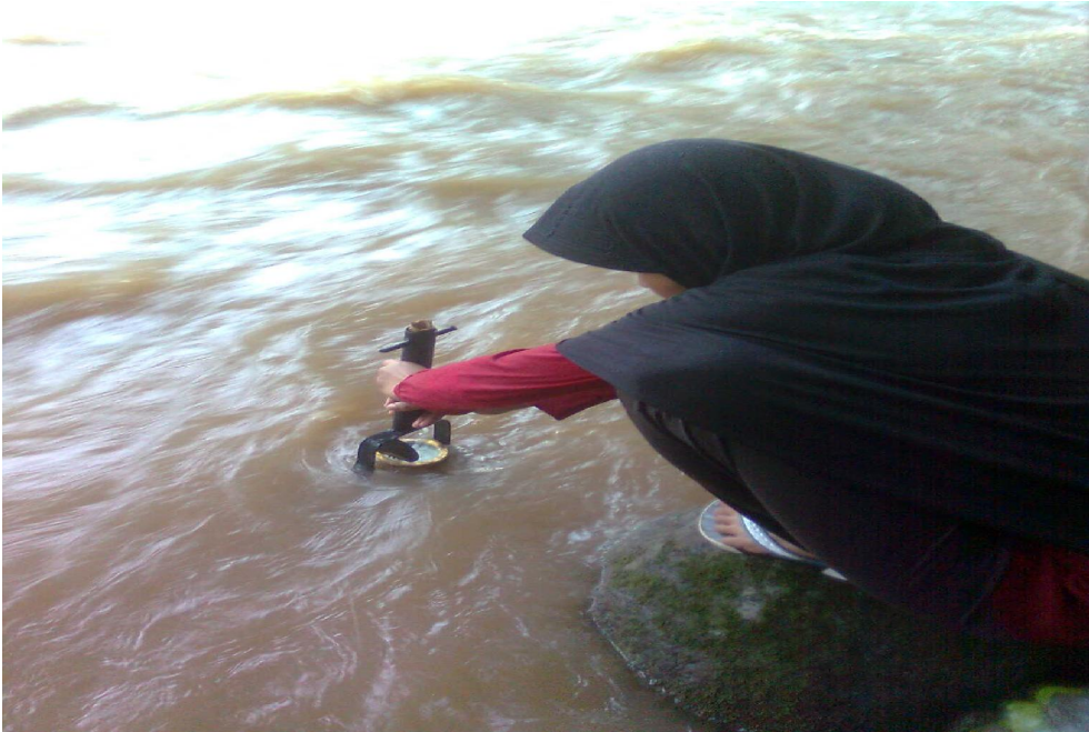
Gambar 3. kegiatan pengukuran debit sungai pada Sub DAS Jenepangkalung
