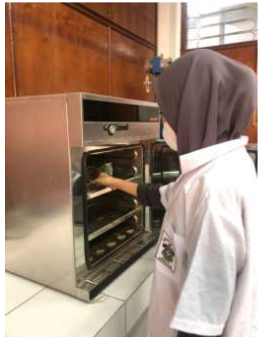
Memasukkan sampel sedimen kedalam oven
