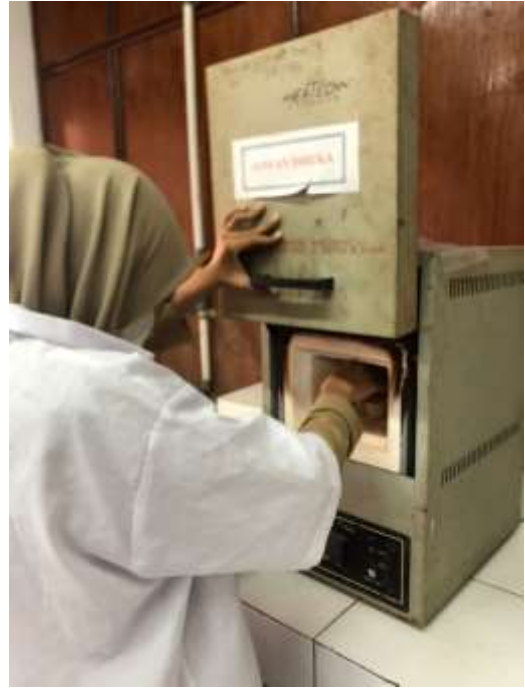
Memasukkan sampel sedimen kedalam tanur
