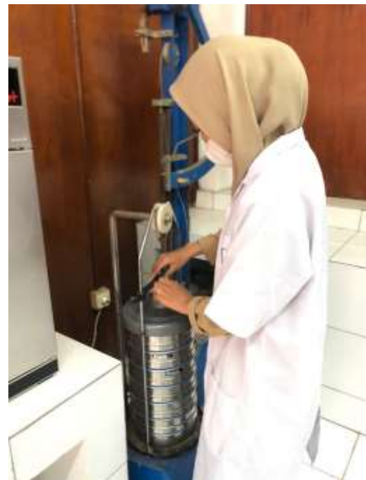
Mengayak sampel sedimen menggunakan Sieve shaker
