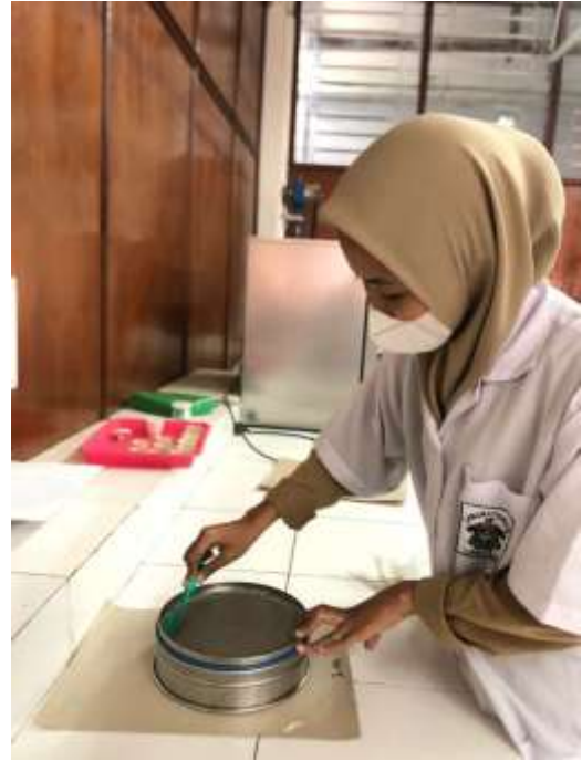
Menyikat sisa-sisa sedimen pada Sieve net
