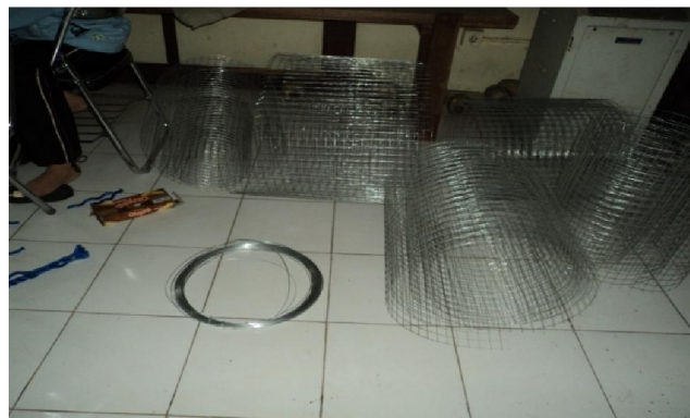
Gambar 9. Rang besi yang digunakan untuk membuat kelopak daun atraktor
