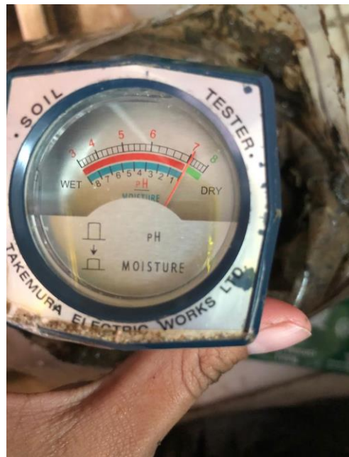
Pengukuran pH sedimen
