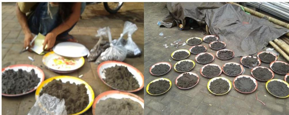
Gambar 3.5 Pengeringan sampel sedimen
