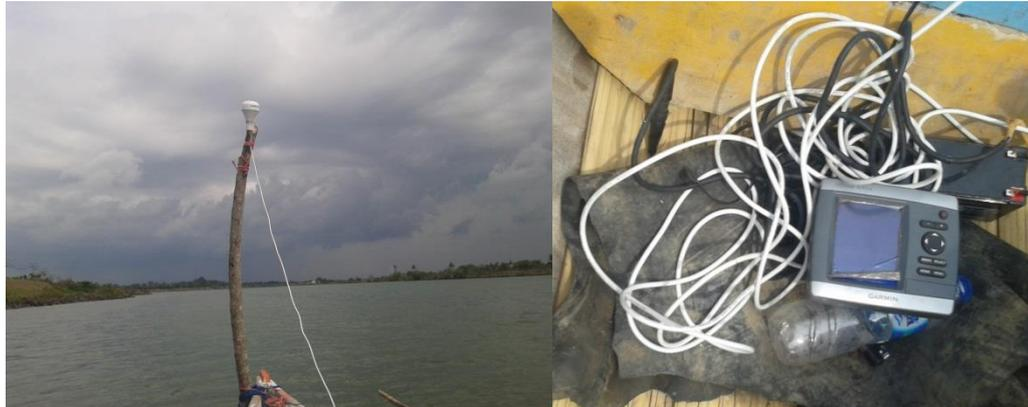
Gambar 3.4 Pengukuran bathimetri muara sungai jeneberang dengan echo sounding
