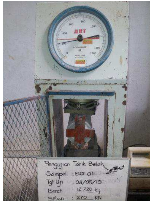
Gambar 4.11. Pengujian kuat tarik belah
