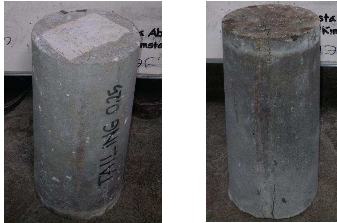
Gambar 4.14. Pola keruntuhan kuat tarik beton fiber
