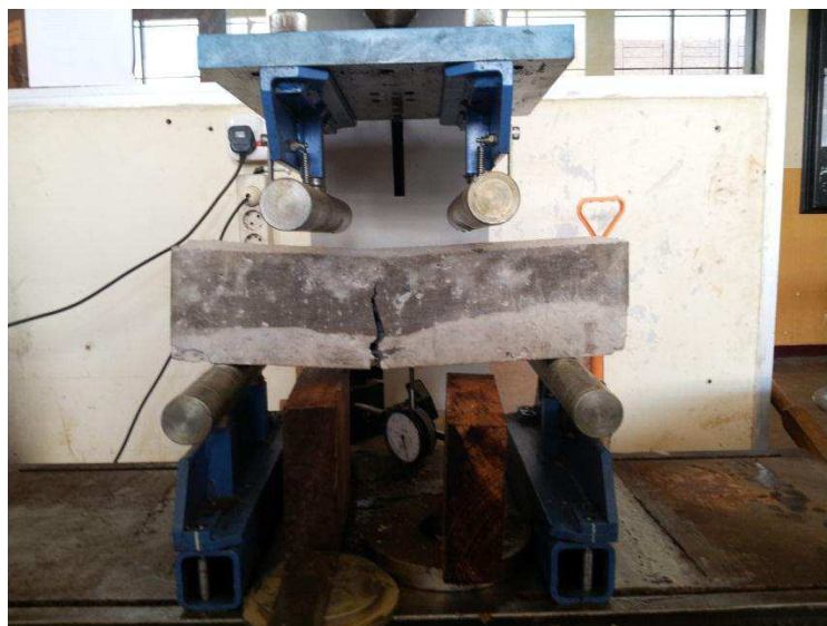
Pengujian Kuat Lentur Beton
