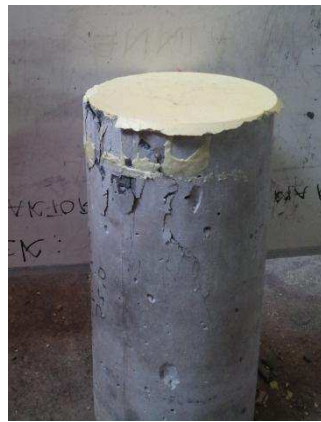
Pola Keruntuhan Beton Setelah Uji Kuat Tekan
