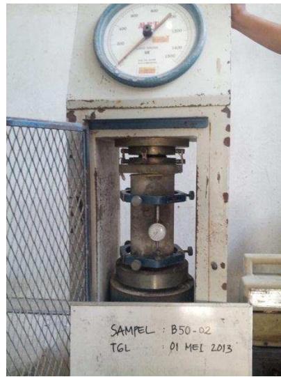
Pengujian Kuat Tekan Beton
