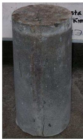
Pola keruntuhan kuat tarik beton fiber
