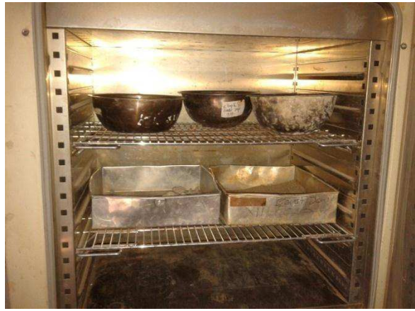
Pengujian Kadar Air
