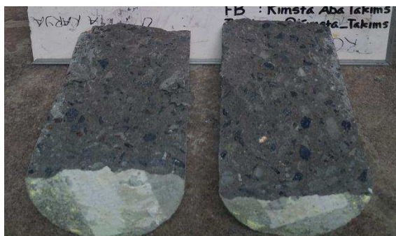
Pola keruntuhan kuat tarik beton normal
