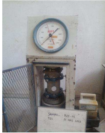
Gambar 4.3. Pengujian kuat tekan beton
