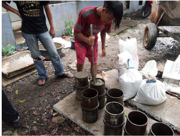
Pembuatan Benda Uji
