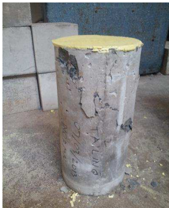
Pola Keruntuhan Beton Setelah Uji Kuat Tekan
