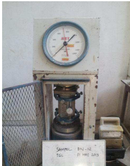
Pengujian Kuat Tekan Beton
