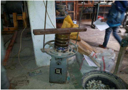
Pengujian Analisa Saringan
