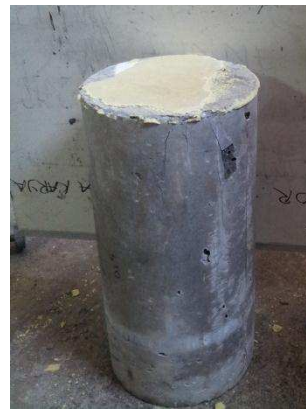
Pola Keruntuhan Beton Setelah Uji Kuat Tekan
