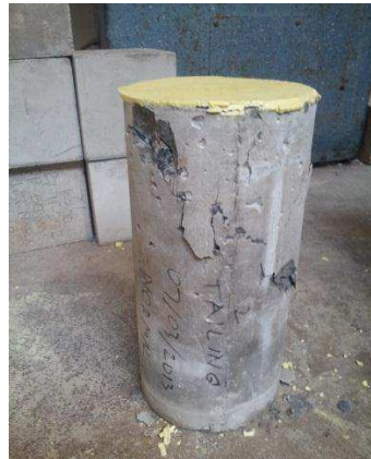
Gambar 4.5. Pola keruntuhan beton nonfiber
