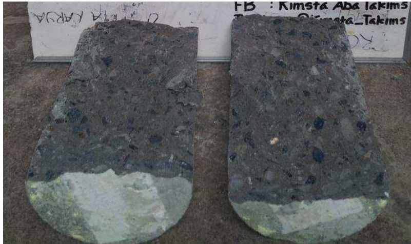
Gambar 4.13. Pola keruntuhan kuat tarik beton nonfiber
