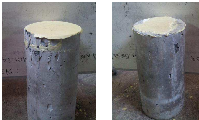
Gambar 4.6. Pola keruntuhan beton fiber
