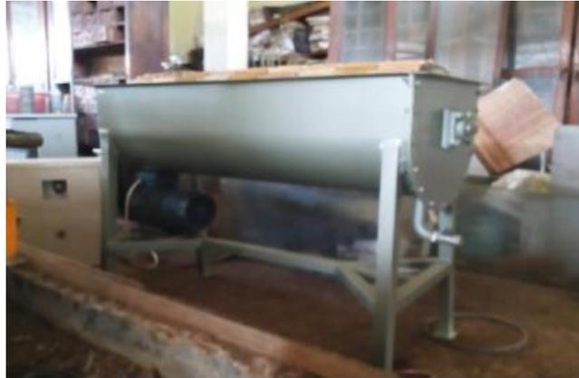
Gambar 2-3. Mesin pencuci kentang tipe silinder
