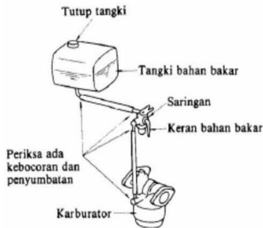
Gambar 2-1. Bagian-bagian dari Komponen pembakaran motor sederhana.
