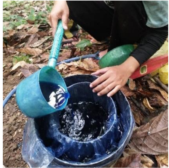
Menuangkan larutan methylene blue ke double ring
