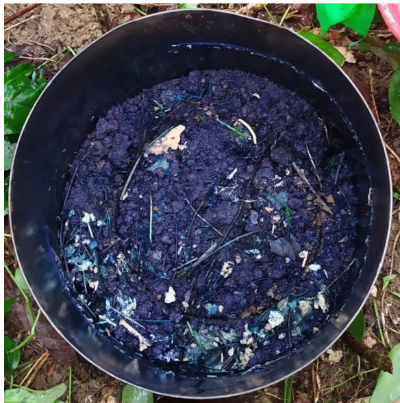
Permukaan tanah yang larutan methylene blue telah terinfiltrasi
