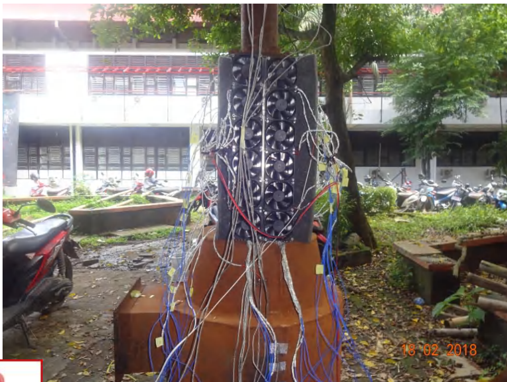
Gambar 2. Dudukan TEG pada cerobong bawah insinerator
