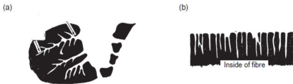
Gambar 6. Struktur pori karbon aktif granular (a) dan fibrous (b) (Manocha, 2003)
