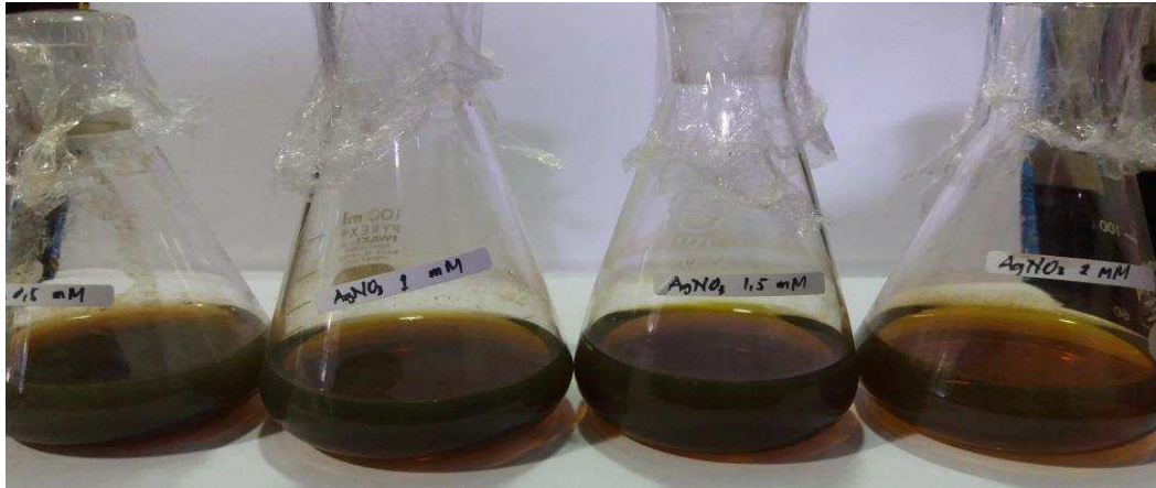
Nanopartikel perak dengan perbandingan konsentrasi larutan \text{AgNO}_3 dan ekstrak daun salam.
