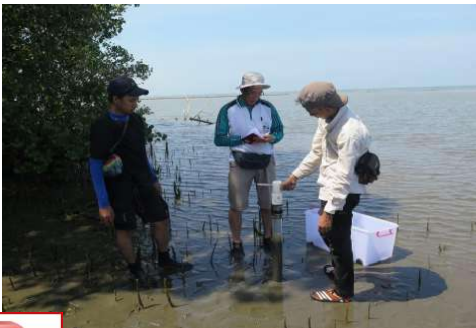
Pengambilan sedimen dengan core sampler
