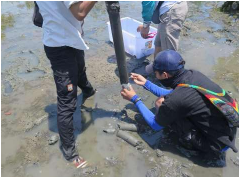
Pengambilan sampel sedimen untuk analisis mikroorganismen dengan botol steril
