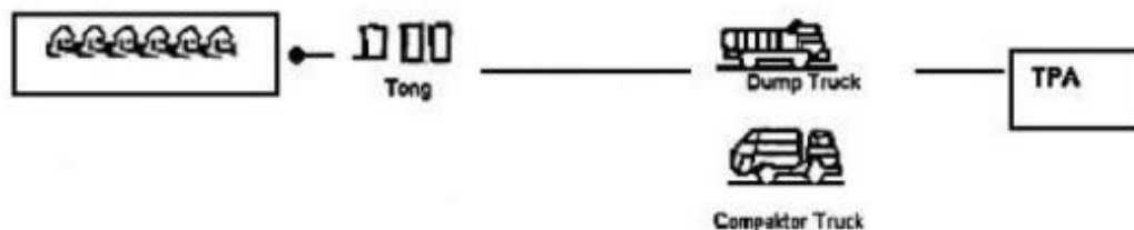
Gambar 2.5 Pola Pengangkutan Sistem Pengumpulan Individual Langsung Sumber: SNI 19-2454-2002
